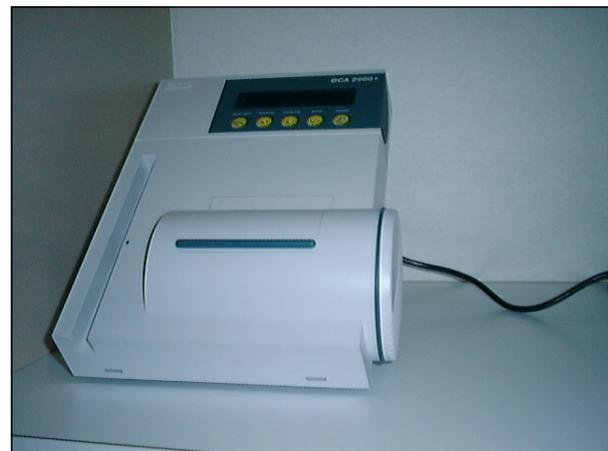
血液検査というと、試験管を振って検査をするように思われるかもしれませんが、この器械は写真②のスライド(2.5cm四方)に血液を1滴(百分の1cc)付けて反応させて結果を出します。1項目につき5~6分で結果が出ます。
